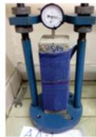
Uji susut: sampel balok beton
