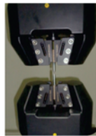
Uji tarik baja tulangan
